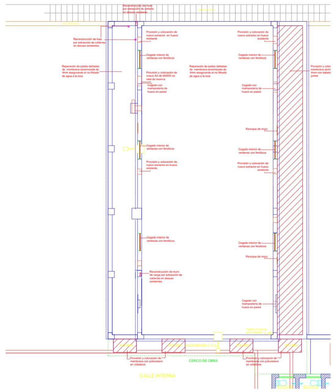
**REPARACIÓN ESTRUCTURAL:** Se realizará en el Bioterio Central y consistirá en un cateo de las partes en mal estado y en la reparación de las mismas. Considerar el cielorraso del pasillo lateral derecho y el frente del Bioterio Central, que se hallan deteriorados debido a la corrosión de armaduras y agrietamiento de la estructura.
