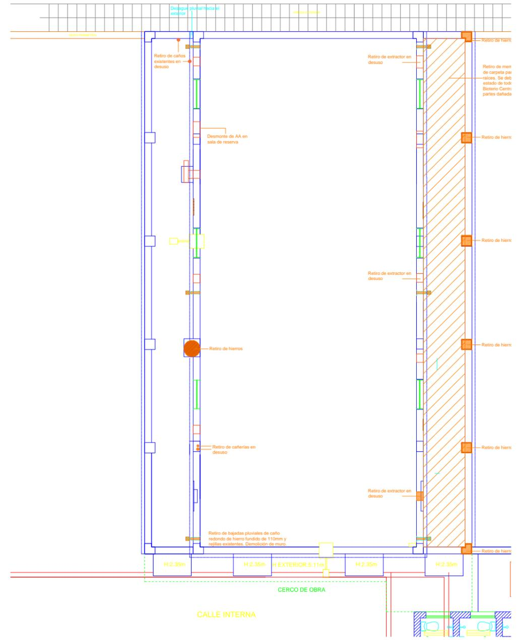
**DESMONTE DEL PISO Y CONTRAPISO INTERNO:** Se demolerá el piso y contrapiso de los pasillos laterales correspondientes al Bioterio Central.
