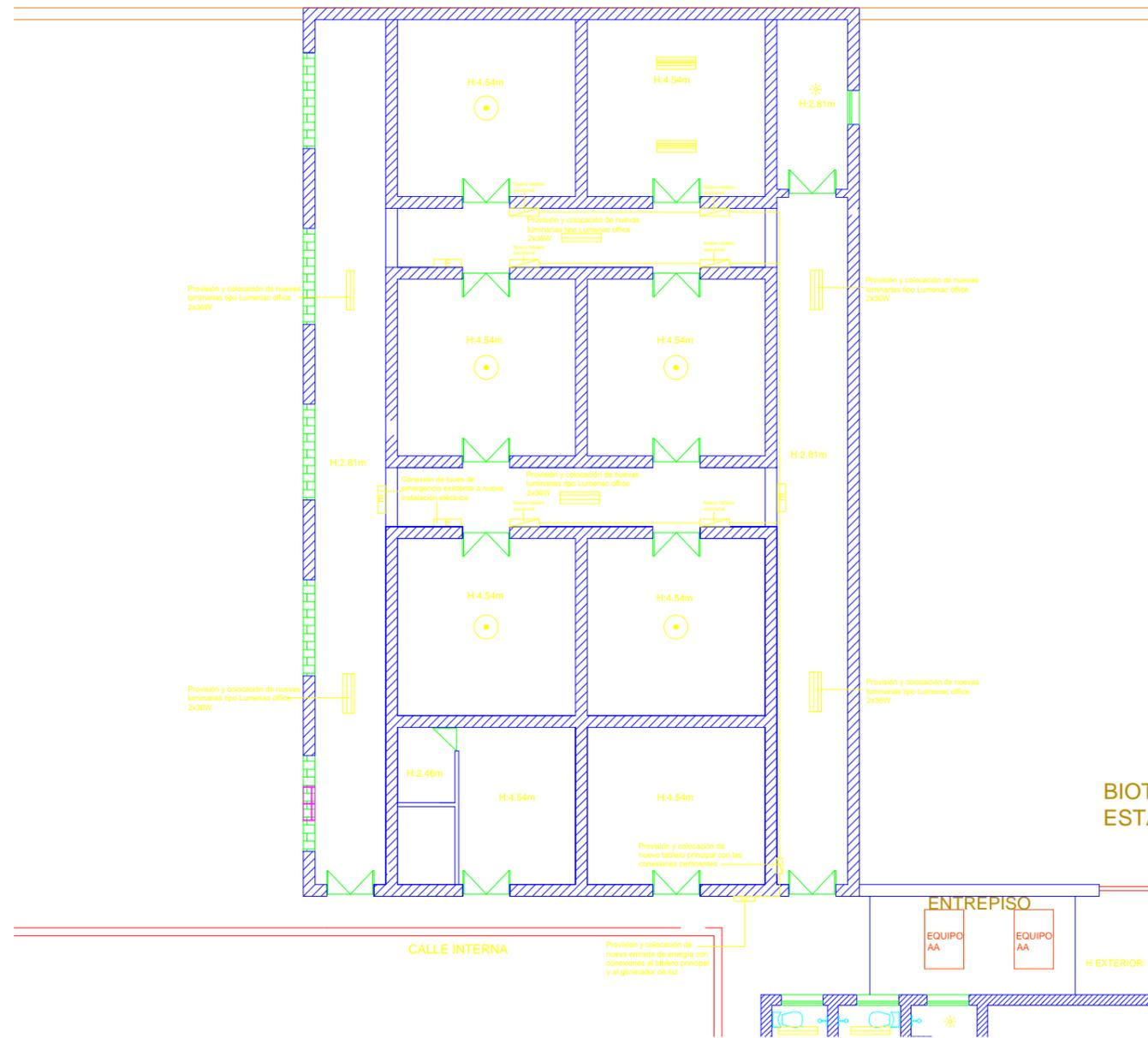
**DESMONTE DE INSTALACIÓN ELÉCTRICA EXISTENTE:** Se retirará la entrada de energía existente y el tablero principal. Se retirarán las luminarias existentes en pasillo y las llaves de luz, tomas y demás elementos eléctricos correspondientes a los pasillos y los bioterios.
