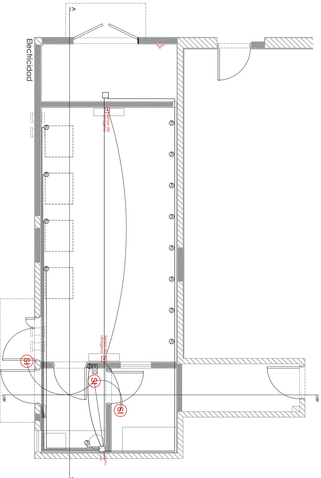
NOTA: SE REALIZARÁN SÓLAMENTE EL TENDIDO DE CAÑERÍA DE 1" Y LA COLOCACIÓN DE CAJAS CIEGAS CON TAPAS CIEGAS
