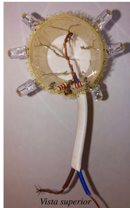
Unir los dos extremos positivos (resistencias), y los dos negativos a otro cable. Pasar el cable doble por la “ventana” del rúler, identificando el cable positivo y el negativo. Aislar cada contacto con cinta y reforzar para evitar puentes no deseados entre LEDs o con las resistencias
