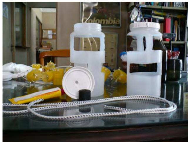
Cerrar la tapa del frasco y marcar donde se encuentran los “pilares” con fibra, para hacer coincidir los espacios sin led del rulero con los pilares del frasco.
